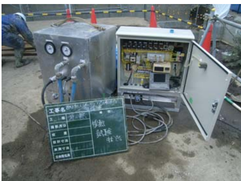
熱応答試験による採熱能力の確認
